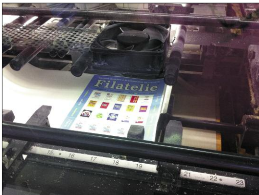
Z poloviny potištěný list samolepícího papíru, na konci dráhy tiskového stroje (před otočením a dalším tiskem na druhou polovinu).
